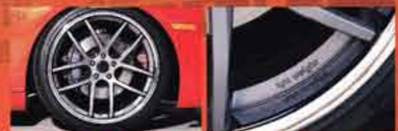
▲今回の取材車に装着されていたのは、22インチのGiovanna MONZA (F-RSJF+00、F-RSJM+35)。ディスク面はプラファイト・グレー。そしてリム部は光り輝くステンレスリップとなっている。ちなみにライトウェイト手法はこのディスクとリムをボルトで組み付けるのではなく、特殊な接着方法で合わせるというもの。これによって驚くほどの軽量化が図られている。タイヤはYOKOHAMA PARADA Spec-Xを指名し、サイズはフロントが255/35-22、リアが285/30-22となっている。
